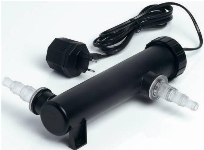
**Комплект лампы UV-C.** Ультрафиолетовый свет диапазона UV-C обезвреживает бактерии, вирусы, и другие низшие микроорганизмы и останавливает их размножение. Корпус изготовлен из специального пластика, который не разрушается под действием ультрафиолетового излучения
