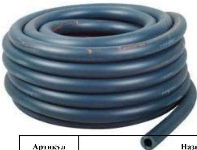
\* Шланг используется для доставки воздуха (газа) к диффузорам (распылителям) и устанавливается в воде. Шланг самопогружной и не требует специального крепления ко дну водоема. Труба ПЭ используется для подачи воздуха по суши.
