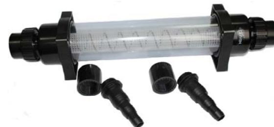
**Фильтр гидроциклонный Hydrosphin.** Фильтр способен обрабатывать поток воды до 30 м<sup>3</sup>/ч при максимальном рабочем давлении 2,5 бар. Монтируется между насосом и фильтром и отделяет твердые частицы размером до 40 мкм. Фильтр имеет устройство для сбора твердых частиц в трех областях: осаждение, очистка и удаление взвесей. Оборудование может быть очищено при помощи 5 литров воды без остановки насоса.
